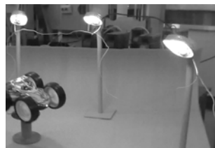
Рис. 3 Внешний вид резонансной однопроводной системы освещения
