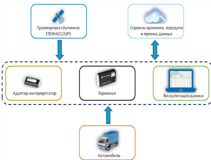
Рисунок 2 – Общая схема осуществления сбора данных мониторинга ТС
